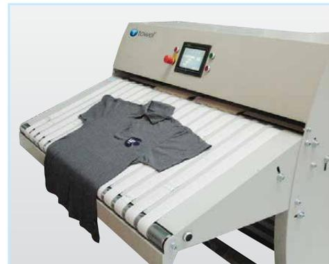
Las piezas se posicionan en la cinta transportadora de admisión. Esta cinta transportadora comienza a funcionar una vez que la pieza es detectada o luego de la activación manual con un botón en el lado de la máquina.
